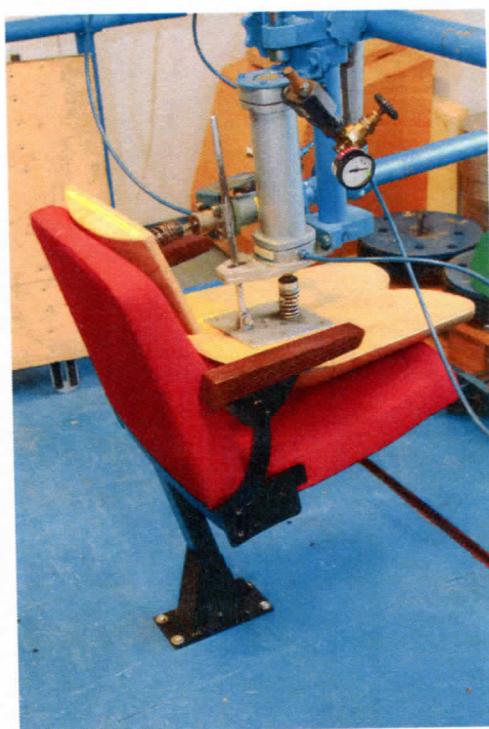
Obr. 9 : Pohľad na kombinovanú skúšku sedadla a operadla
