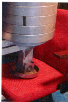
Obr. 6 : Pohľad statickú záťažovú skúšku sedadla
