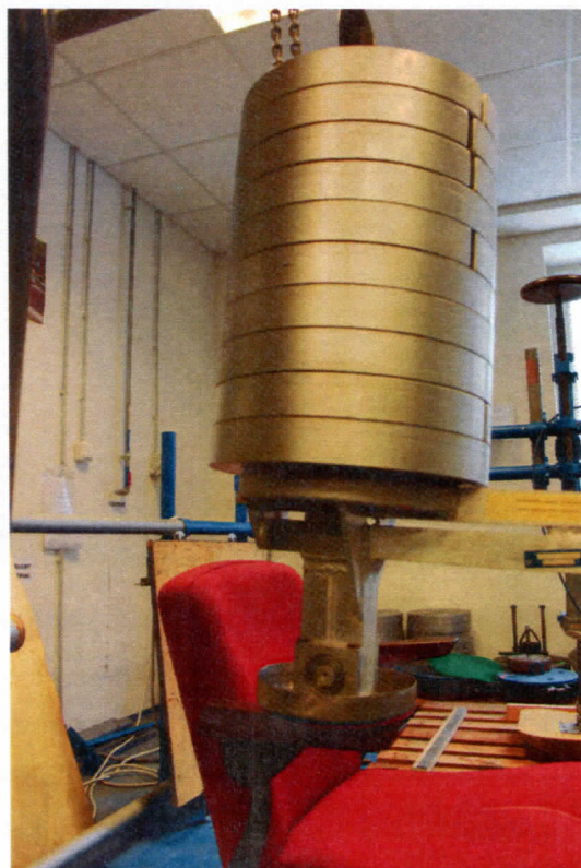
Obr. 8 : Pohľad na statické zaťažovanie opierok závažím smerom dole
