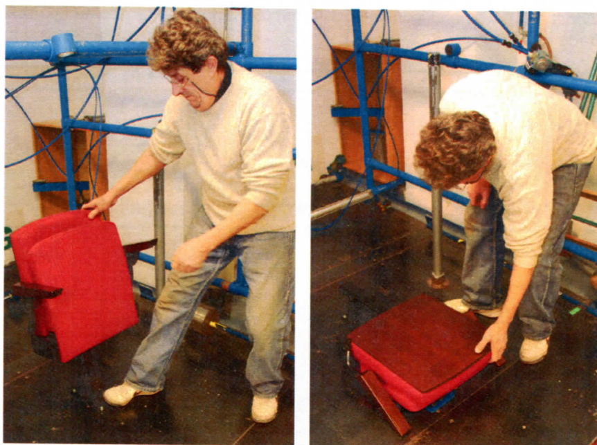
Obr. 13 a 14 : Overovanie funkčnosti istiaceho sklápacieho mechanizmu nohy kresla
