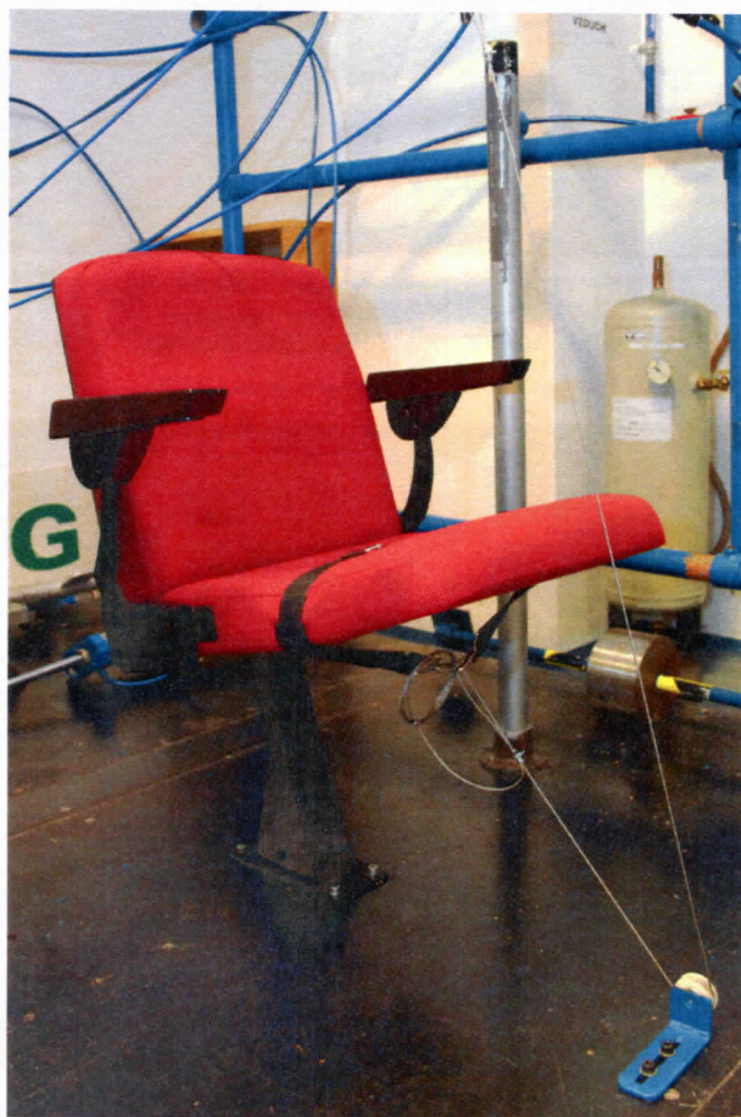
Obr. 12 : Skúška funkčnosti sklápacieho mechanizmu sedadla
