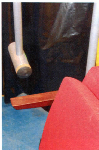
Obr. 11 : Rázová skúška opierok na ruky
