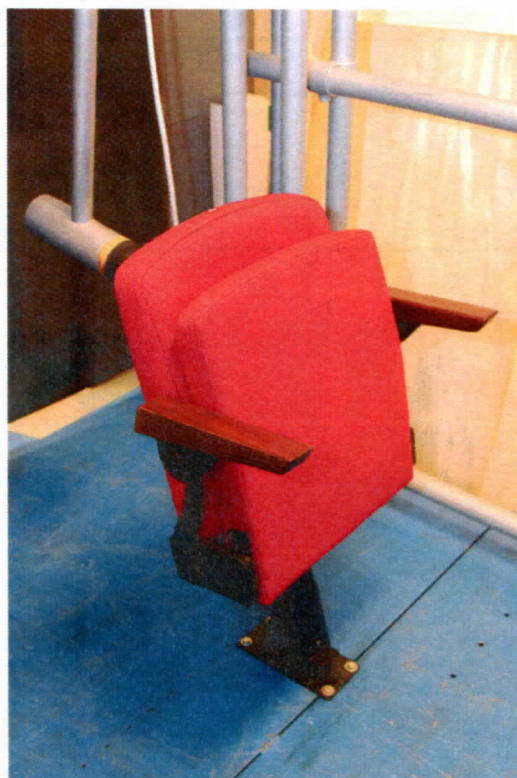
Obr. 10 : Rázová skúška operadla
