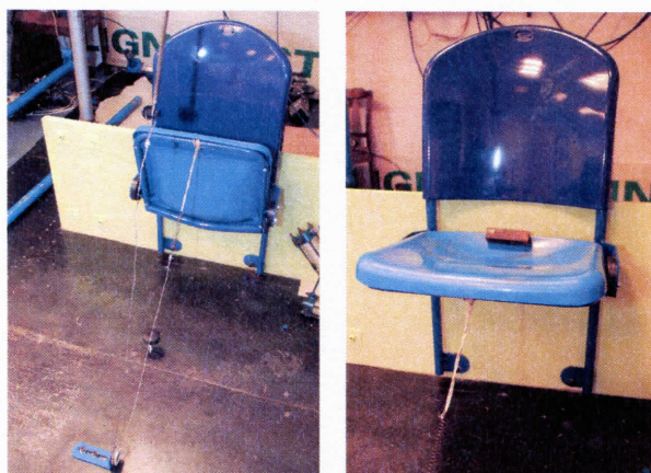
Obr. 7. a 8. : Skúška sklápacieho mechanizmu sedadla
