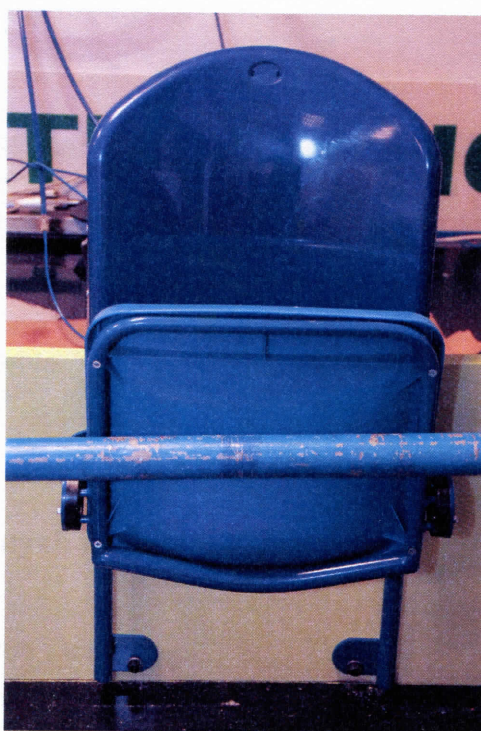
Obr. 2 : Pohľad na sklopné sedadlo TORONTO, ukotvené na skúšobný panel
