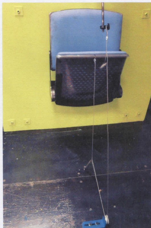
Obr. 7. a 8. : Skúška sklápacieho mechanizmu sedadla
