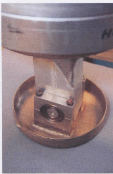
Obr. 4 : Pohľad statickú záťažovú skúšku sedadla
