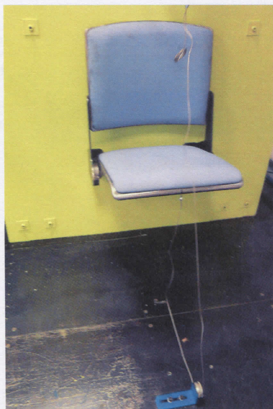
Obr. 7. a 8. : Skúška sklápacieho mechanizmu sedadla
